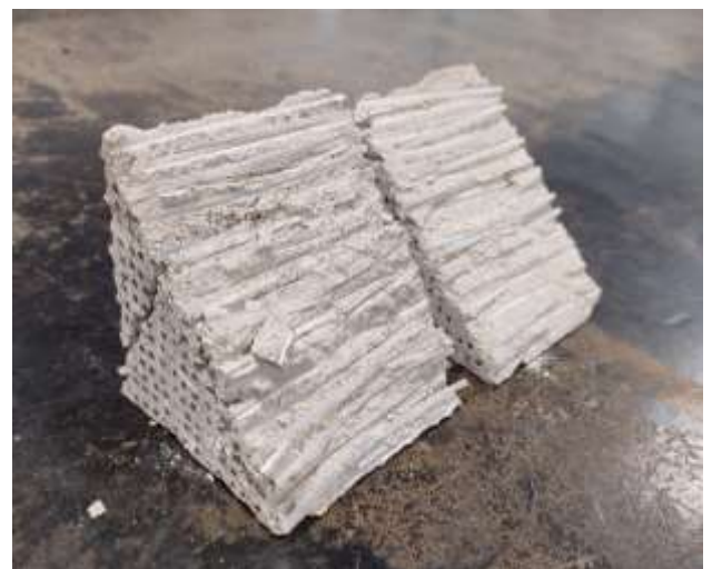
Figura 13 – Corpos de prova com fibras rompidos
