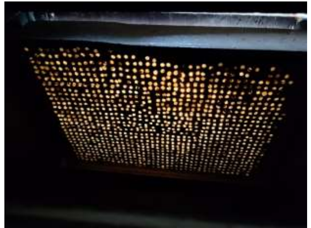
Figura 16 – Painel de concreto translúcido iluminado
