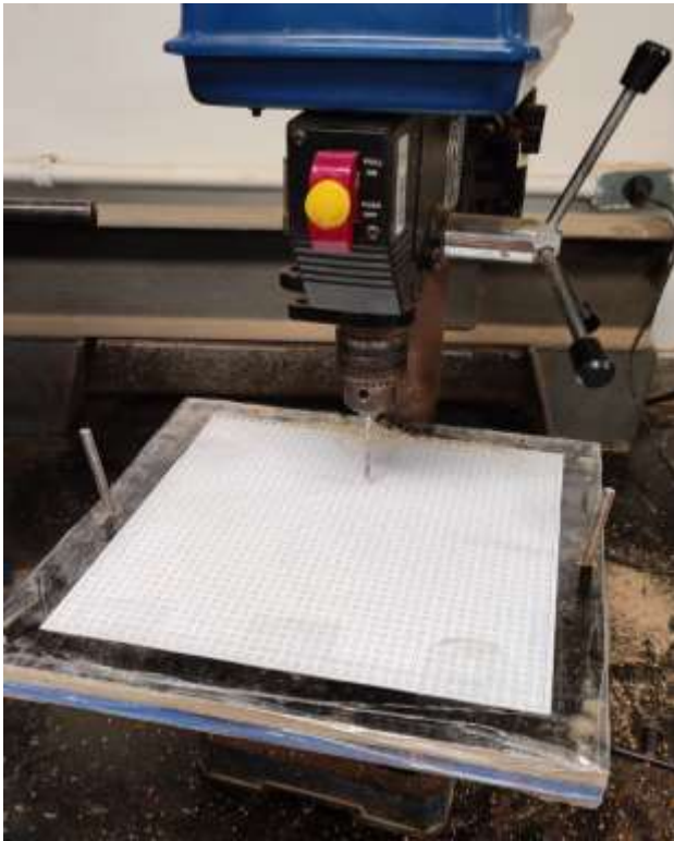
Figura 8 - Processo de furação da forma do painel
