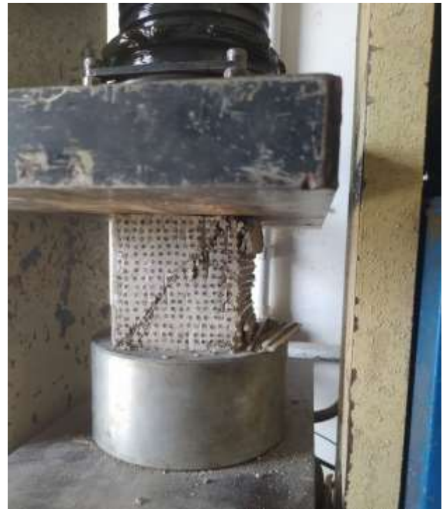
Figura 12 – Momento do rompimento do corpo de prova com fibras
