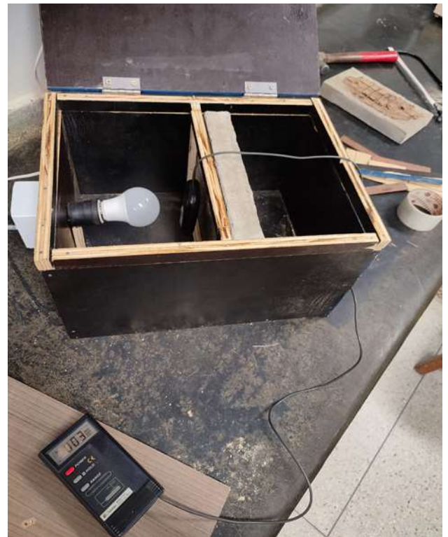
Figura 10 – Caixa confeccionada e utilizada para os testes de translucidez do material
