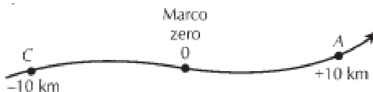
Figura 4; A posição do móvel A fica definida pela medida algebrica +10 Km. e a do C -10 Km.
