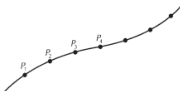
Figura 2; O móvel ocupa as posições P_1, P_2, \dots nos instantes sucessivos t_1, t_2, \dots a linha que contém os pontos é a trajetória.
