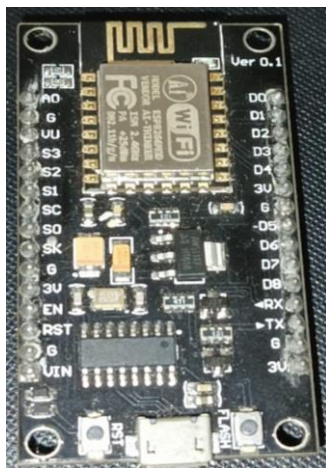
Figura 4: Imagem real da placa eletrônica com o módulo ESP 12E
