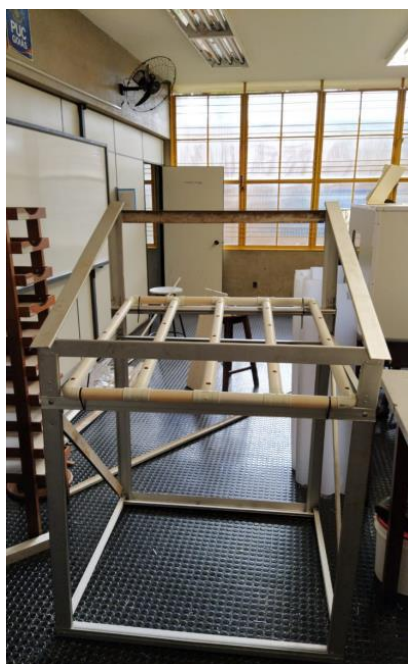
Figura 16 - Base com suporte para telhado e tubulações
