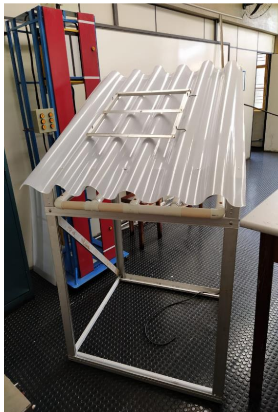
Figura 17 - Estrutura com telhado e suporte para placa
