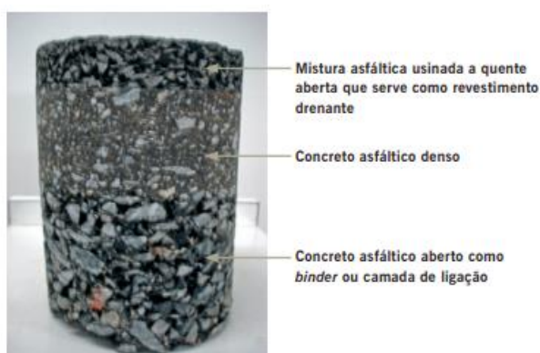
Figura 1 – Composição do Asfalto Convencional. Fonte: Bernucci et al (2006).
