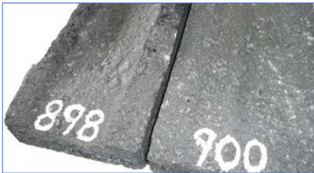
Figura 8 – Placas após serem submetidas ao simulador de tráfego (a esquerda asfalto convencional e a direita, asfalto-borracha). Fonte: Greca Asfaltos (2004).
