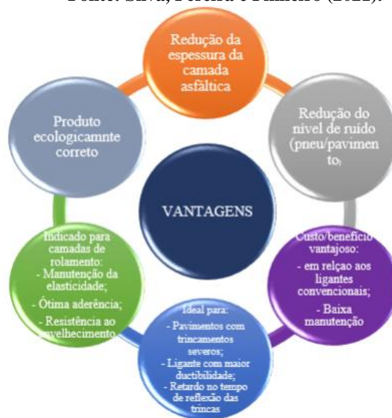
Figura 5 – Vantagens técnicas do asfalto-borracha. Fonte: Silva, Pereira e Pinheiro (2021).
