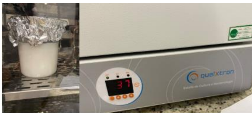
Figura 10 - Fermentação da bebida em uma estufa.
