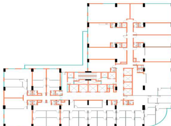
Figura 9 – Planta baixa alvenaria com blocos cerâmicos.
