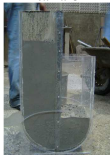
Figura 11 – Concreto não estabilizado em caixa U
