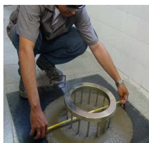
Figura 6 – CAA passando pelo anel J
