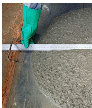
Figura 4 – Medida do espalhamento do CAA
