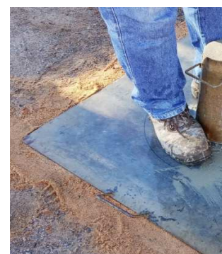
Figura 5 – Cone de Abrams preenchido com CAA
