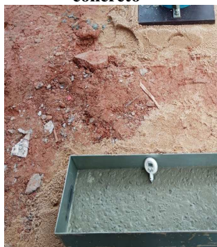
Figura 9 – Caixa L com concreto
