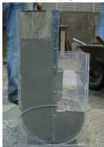
Figura 11 – Concreto não estabilizado em caixa U
