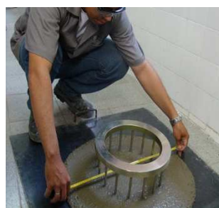
Figura 6 – CAA passando pelo anel J
