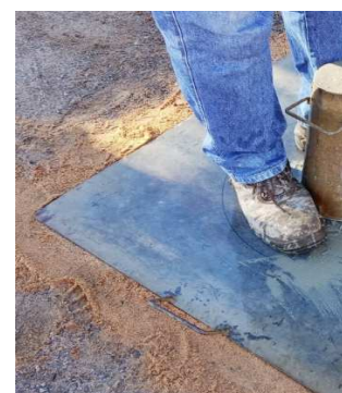
Figura 5 – Cone de Abrams preenchido com CAA
