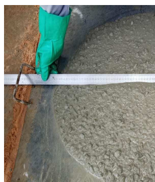
Figura 4 – Medida do espalhamento do CAA
