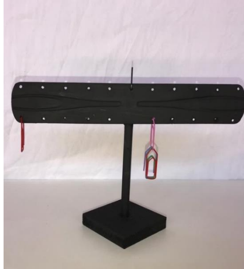
Figura 2.7: Experimento 4: cinco cliques no furo 12 e um clipe no furo 0.
