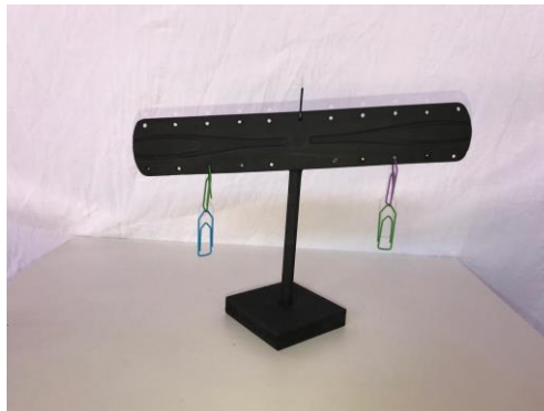
Figura 2.5: Experimento 2: cliques pendurados nos furos 6 e 16.
