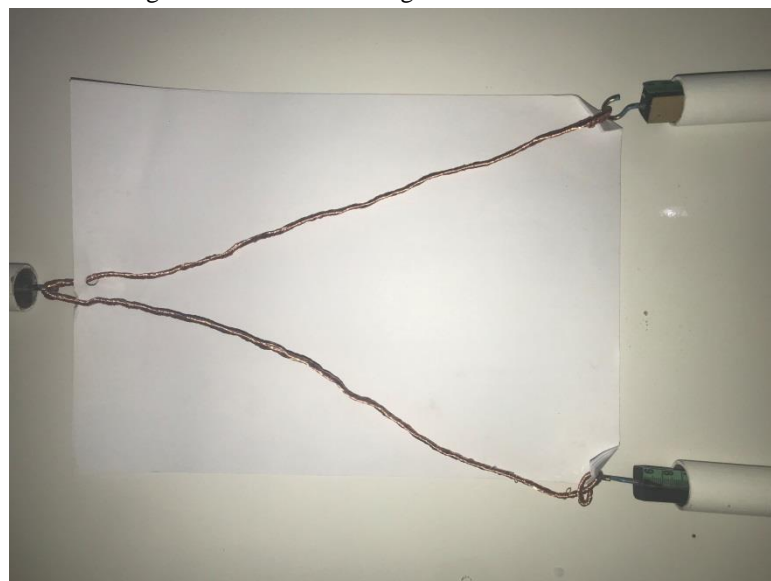
Figura 9.3: Arame rígido formando um triângulo com um dinamômetro em cada vértice.
