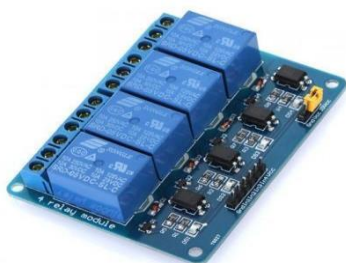
Fig. 6. Módulo relé 5V com 4 canais Fonte: [6]
