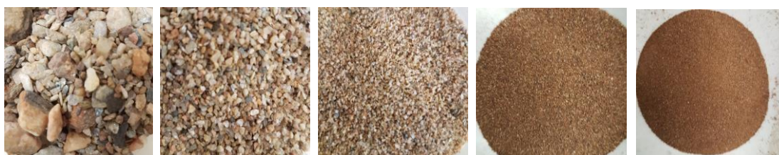
Figura 3. Grânulos retidos em malhas de 2,0 mm; 1,0 mm; 500 \mu\text{m} ; 250 \mu\text{m} e 106 \mu\text{m} da esquerda para a direita em diferentes amostras.
