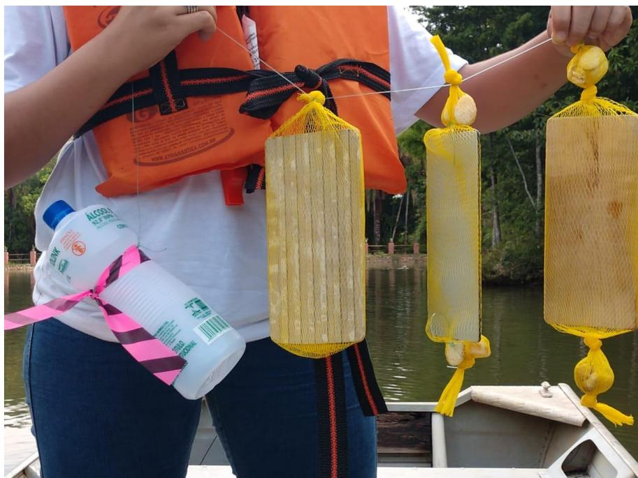
**Figura 5:** Conjunto de coletores com substrato artificiais (M) madeira, (A) alumínio, (C) cerâmica, utilizados para amostragem na comunidade de invertebrados bentônicos na represa do córrego São Nicolau no Campus II da PUC Goiás, em Goiânia-GO.
