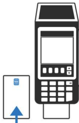
Figura 8 - Exemplo de transação com contato ( contact )
