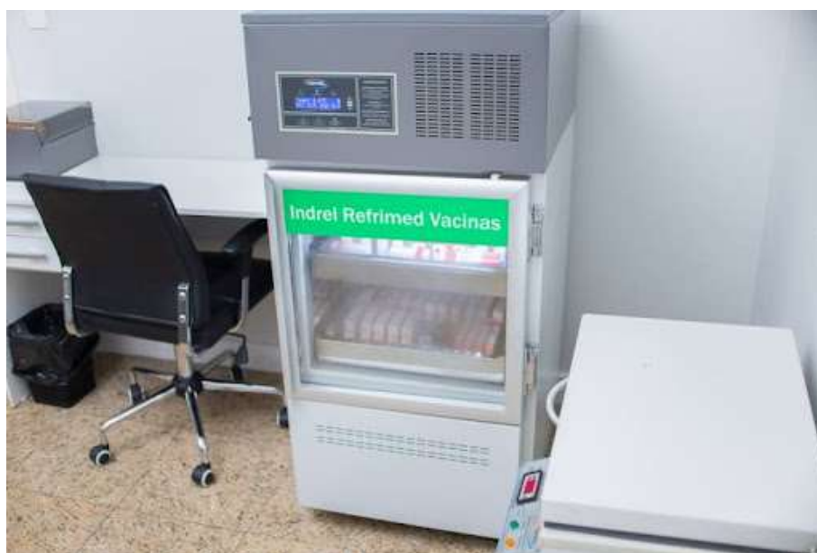
Câmara de conservação de vacinas Indrel Refrimed. Fonte: Google Imagens 51
