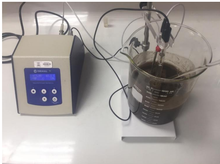
Figura 3: Medição do pH da casca de banana triturada com pHmetro
