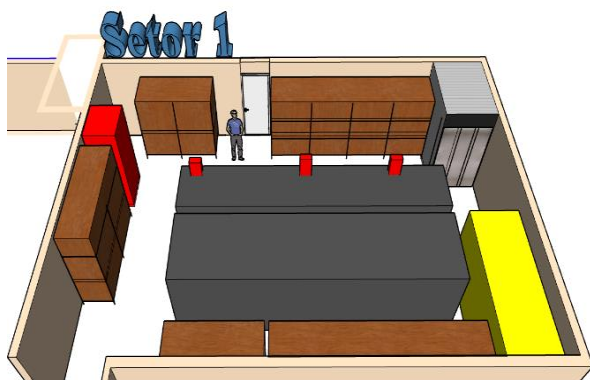
Figura 7 – Estoques encostados nas paredes
