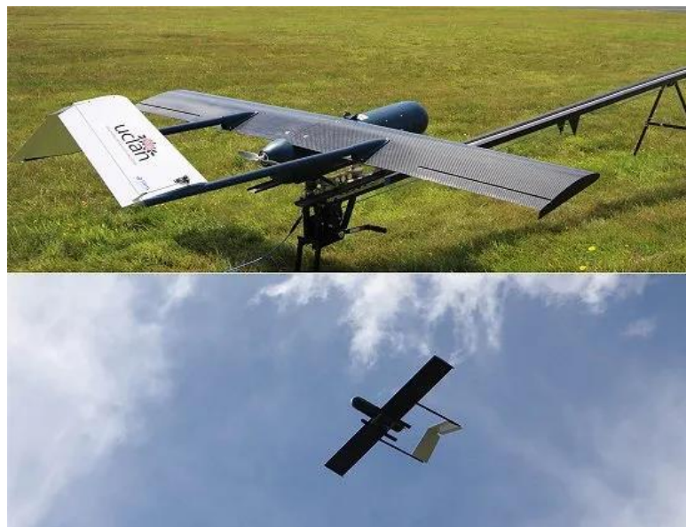
Figura 2 – Prospero avião com asa de grafeno.
