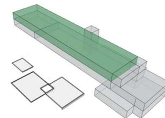
**Planta de cobertura** projetadas para telhas isotérmicas com inclinação de 15%, com grandes calhas instalada antes do beiral, Para facilitar o processo de manutenção da cobertura, ela divide as placas fotovoltaicas das placas de aquecimento solar de água .
