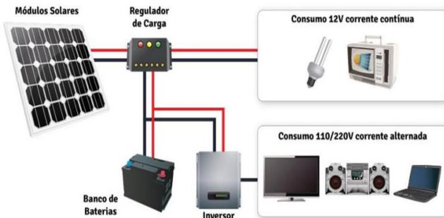
Fig. 1. Exemplo de sistema isolado doméstico [7].
