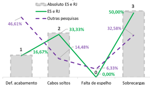
Figura 13 – Manifestações patológicas identificadas nas instalações elétricas
