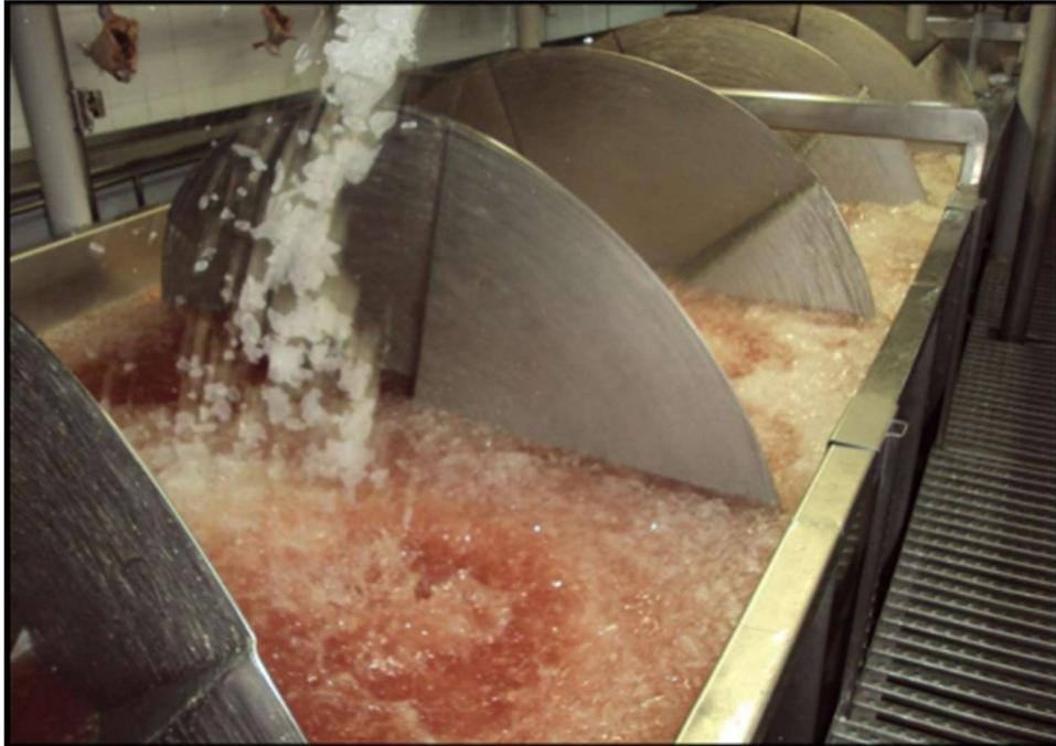
FIGURA 3 – Etapa de resfriamento utilizando o equipamento chiller por imersão em água de um abatedouro comercial
