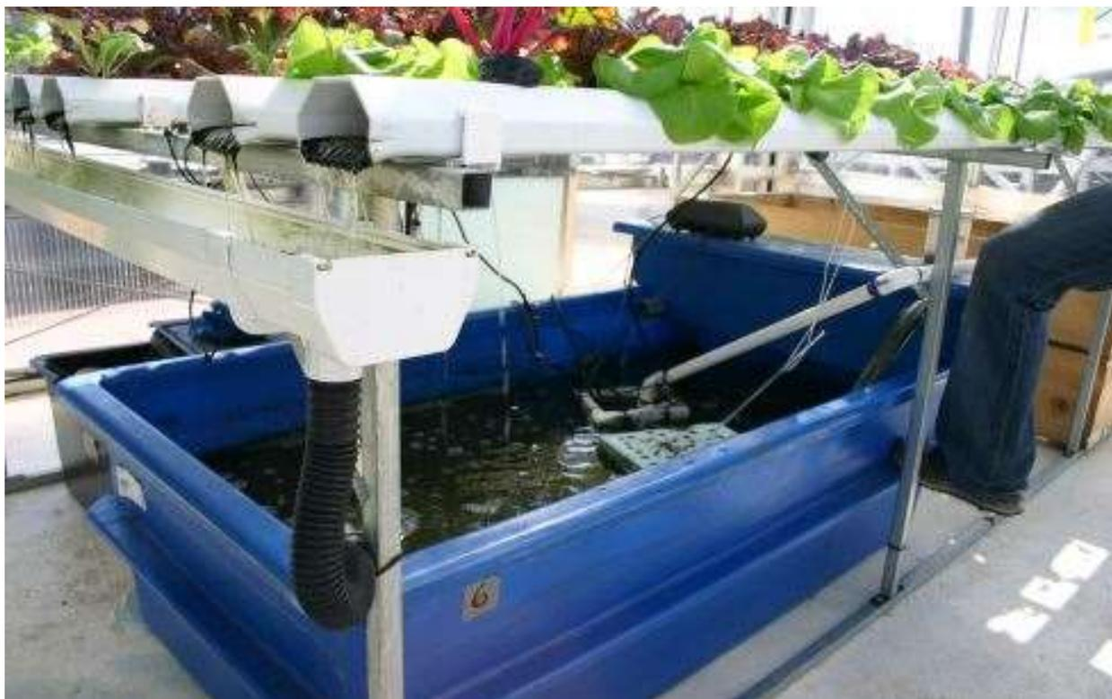
**Figura 8-** Sistema em NFT por bombeamento, tanque, e canaletas em PVC com as plantas.
