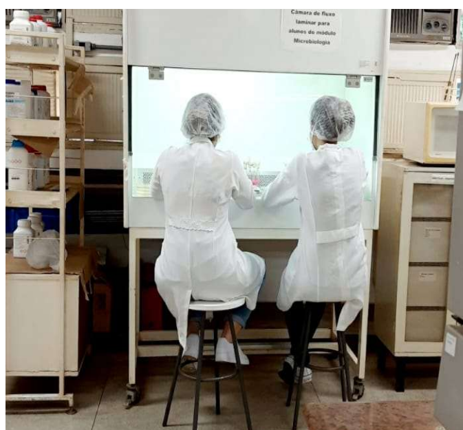
Figura 1. Utilização da cabine de segurança biológica classe II durante a realização dos experimentos microbiológicos.
