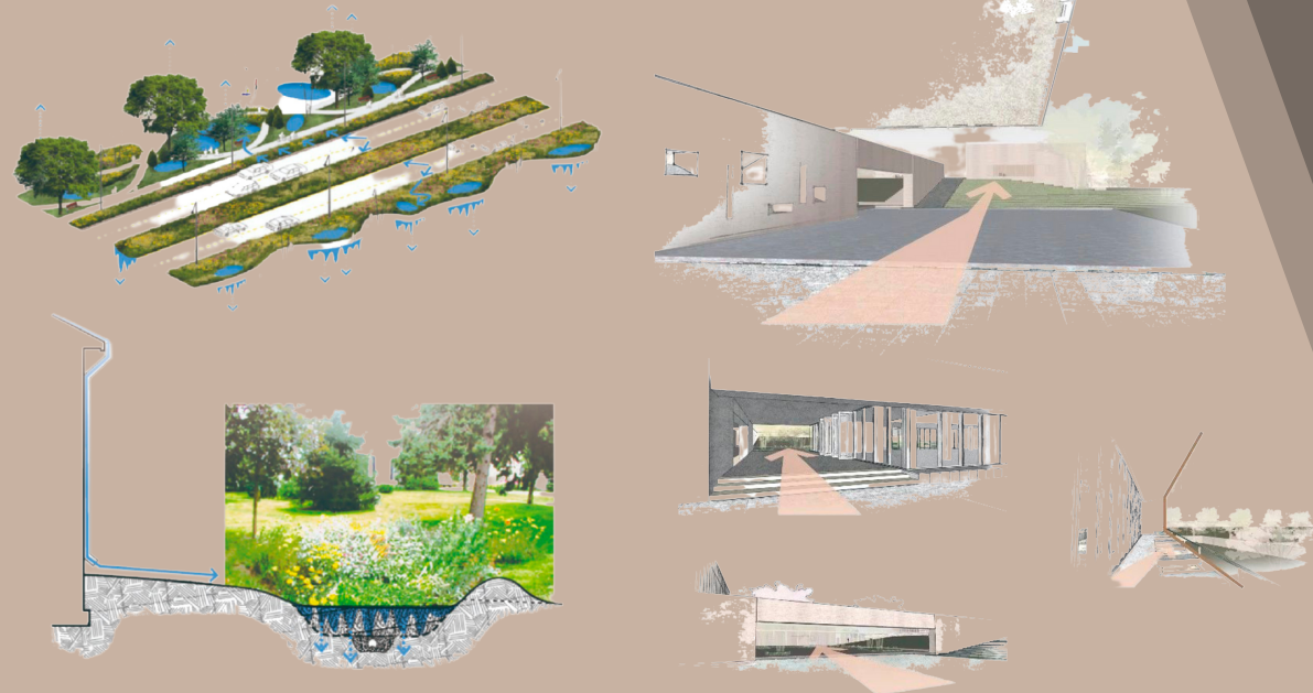
Fig. 7: Jardins de chuva e fluxograma entre edifícios Fonte: https://www.archdaily.com/923022/ideal-land-art-and-culture-center-verse-design | Acesso: 22 de set. de 2021
