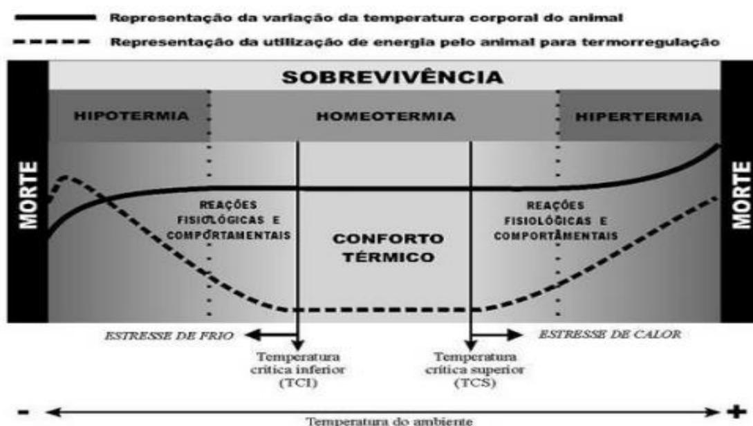
Figura 3: Representação dos limites do conforto térmico pela temperatura crítica inferior e temperatura crítica superior.
