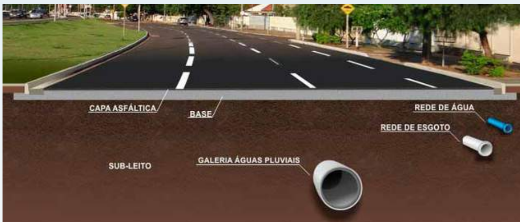
Figura 70- Representação Infraestrutura Urbana Fonte: Google
