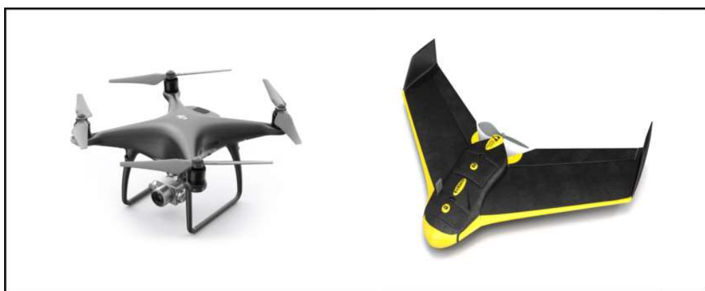
Figura 4: Tipos de VANTS: multirotor, a esquerda e asa fixa a direita. (google imagem, 2021) Fonte: https://adenilsongiovani.com.br/blog/vant-o-que-e-e-quais-os-tipos-existent/vant-e-drone/ (acessado em 10 de outubro de 2021).
