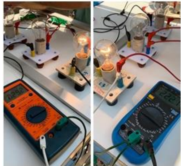
Figura 15 – Amperímetro e Voltímetro, respectivamente, medindo corrente e tensão das cargas. Fonte: Autores
