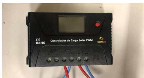
Figura 05. Controlador de carga.
