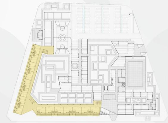
As Habitações contam uma enorme parede grossa sem aberturas, voltada para aquela fachada mais quente, enquanto a entrada de ventilação natural fica voltada para as fachadas sudeste e sudoeste. O estudo de insolação msotrado na prancha anterior compro que ao longo de um ano, as fachadas residenciais recebem com mais intensidade aquele sol do começo da manhã e do final da tarde.
