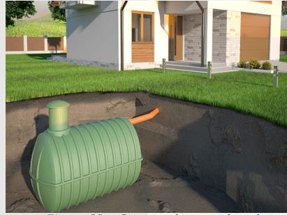
Figura 29 - Cisterna de água pluvial Fonte: Casa e Construção
