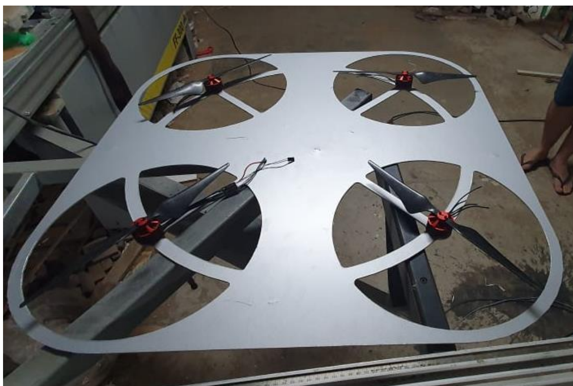
Figura 42: Fixando motores a base.
