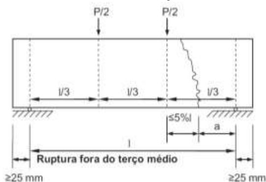
Figura 3 – Posicionamento e análise de fissuras no ensaio de resistência à tração na flexão
