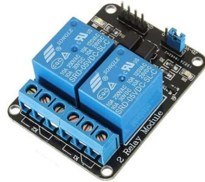
Fig. 7. Módulo relé. Fonte: [32]
