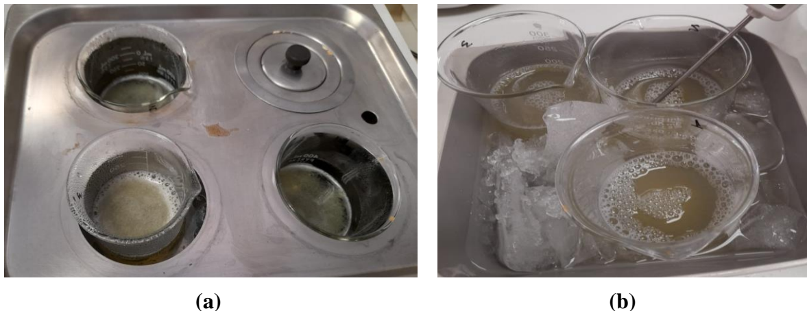
Figura 4 – Aquecimento em banho – maria (a) e Resfriamento em banho de gelo (b)
