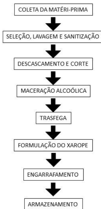
Figura 03. Fluxograma da Produção do Licor Doce à Base de Cascas de Banana Nanica.
