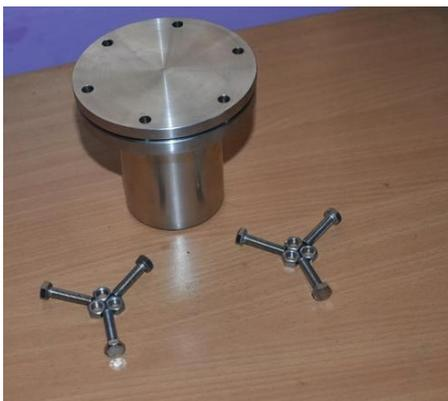
Figura 10. Flange de proteção dos sensores
