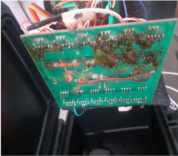
Figura 12. Sujeira advinda do equipamento autoclave.
