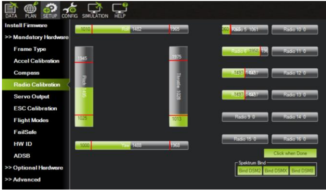
Figura 9. Calibração do Controle de Rádio Fonte: autores do trabalho
