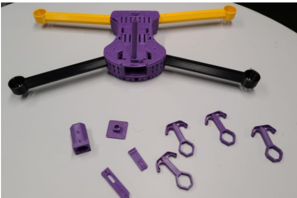
Figura 6. Estrutura impressa do protótipo Fonte: autores do trabalho
