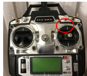
Figura 10. Seletor do modo de voo no RC Fonte: autores do trabalho
