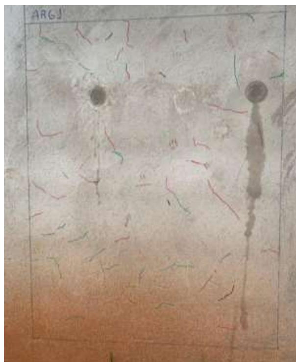
Figura 10 – Análise de formação de fissuras (ARGI)
