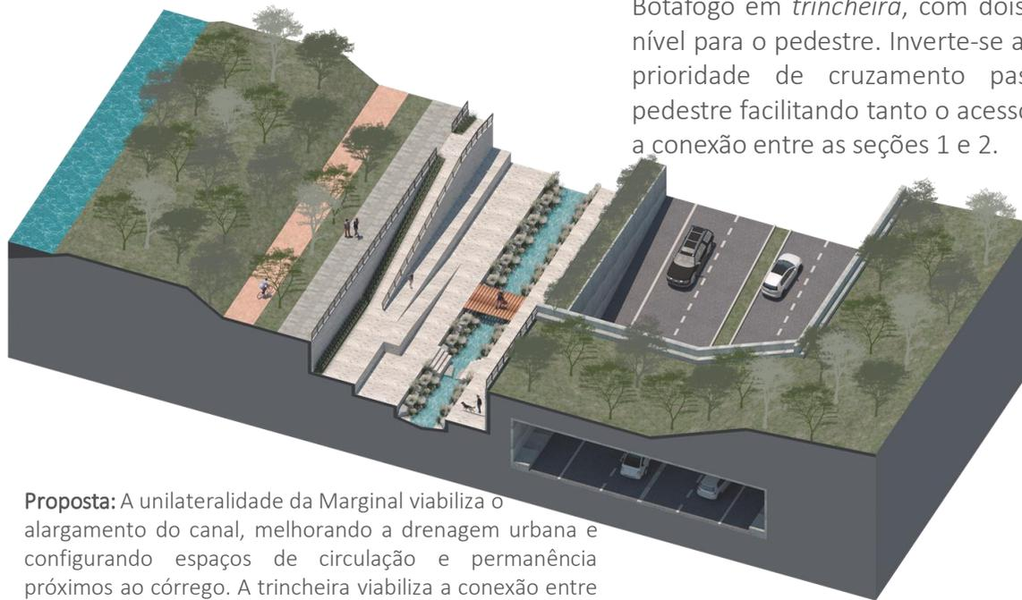
**Proposta:** A unilateralidade da Marginal viabiliza o alargamento do canal, melhorando a drenagem urbana e configurando espaços de circulação e permanência próximos ao córrego. A trincheira viabiliza a conexão entre as seções 1 e 2 e o acesso ao Córrego pela seção 1.
