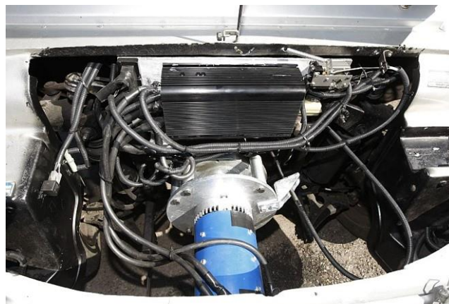
Figura 11. Conversão de um Carro a Combustão em Elétrico [10]
