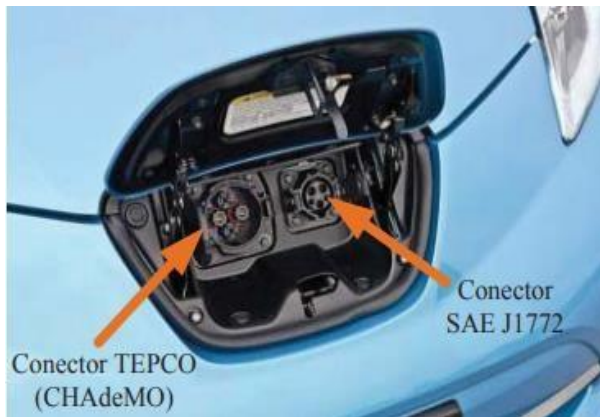
Figura 13. Utilização de mais de um tipo de conector para recarga [16]
