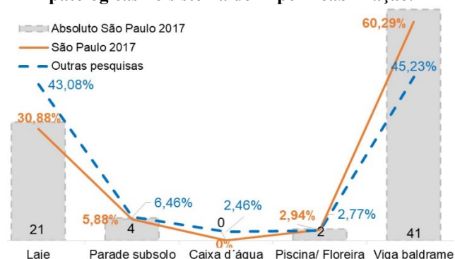
Figura 14 – Locais da incidência das manifestações patológicas no sistema de impermeabilização.
