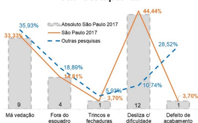
Figura 15– Manifestações patológicas identificadas no sistema de esquadrias.
