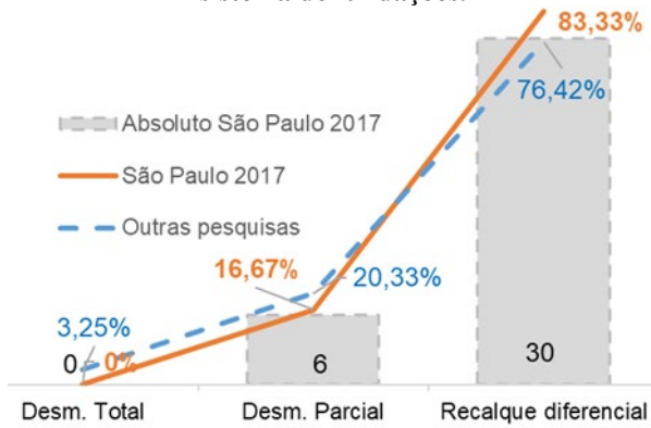
Figura 08 – Manifestações patológicas identificadas no sistema de fundações.
