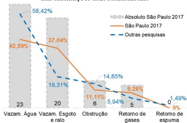
Figura 12 – Manifestações patológicas identificadas nas instalações hidrossanitárias.
