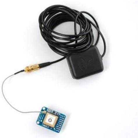
Figura 8 – Kit de um receptor GPS.
