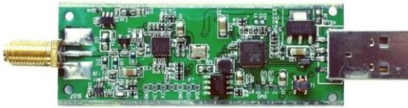
Figura 12. Receptor RTL-SDR.
