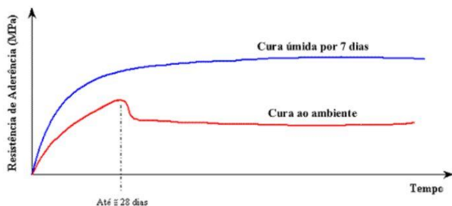
Figura 3 - Representação esquemática do comportamento típico entre as resistências de aderência ao longo do tempo para as situações de cura úmida e cura ao ambiente.
