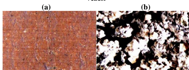
Figura 1 - Vista da superfície dos blocos (a) cerâmico (b) concreto através de lupa estereoscópica – Aumento de 50 vezes.
