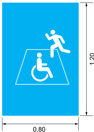
Figura 64 – Área de resgate para pessoa com deficiência
