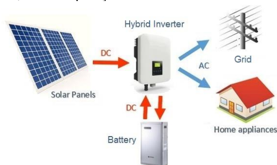
Fig. 3. Diagrama básico de um sistema solar com inversor híbrido [11].
