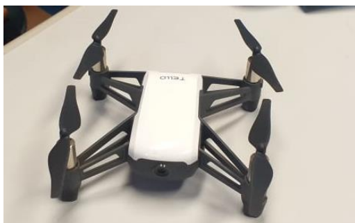
Figura 4 – Drone utilizado na inspeção da fachada.
