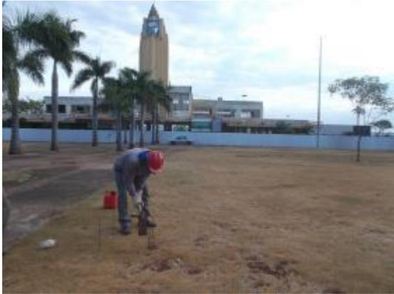
Figura 18: Escavação da sondagem TD 49 sendo realizada. Fonte: Marcelo lury, 2018.
