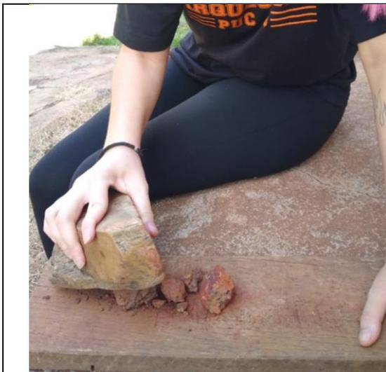
**Figura 8:** Fragmentação da rocha sobre um percutor duro.
