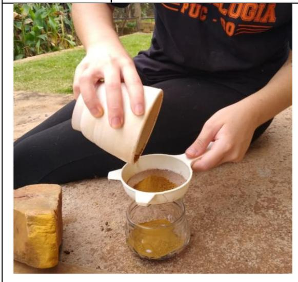
**Figura 10:** Processo de peneiramento.
