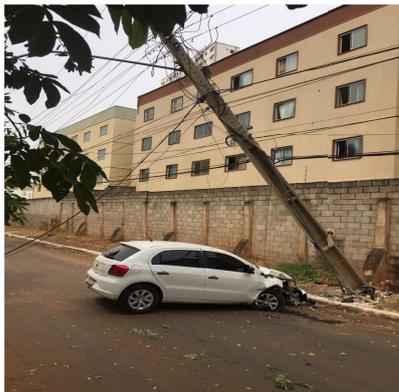
Figura 25. Colisão de veículo com poste de energia.
