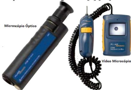
Figura 19. Microscópio para ver se há sujeira na *FO*.
